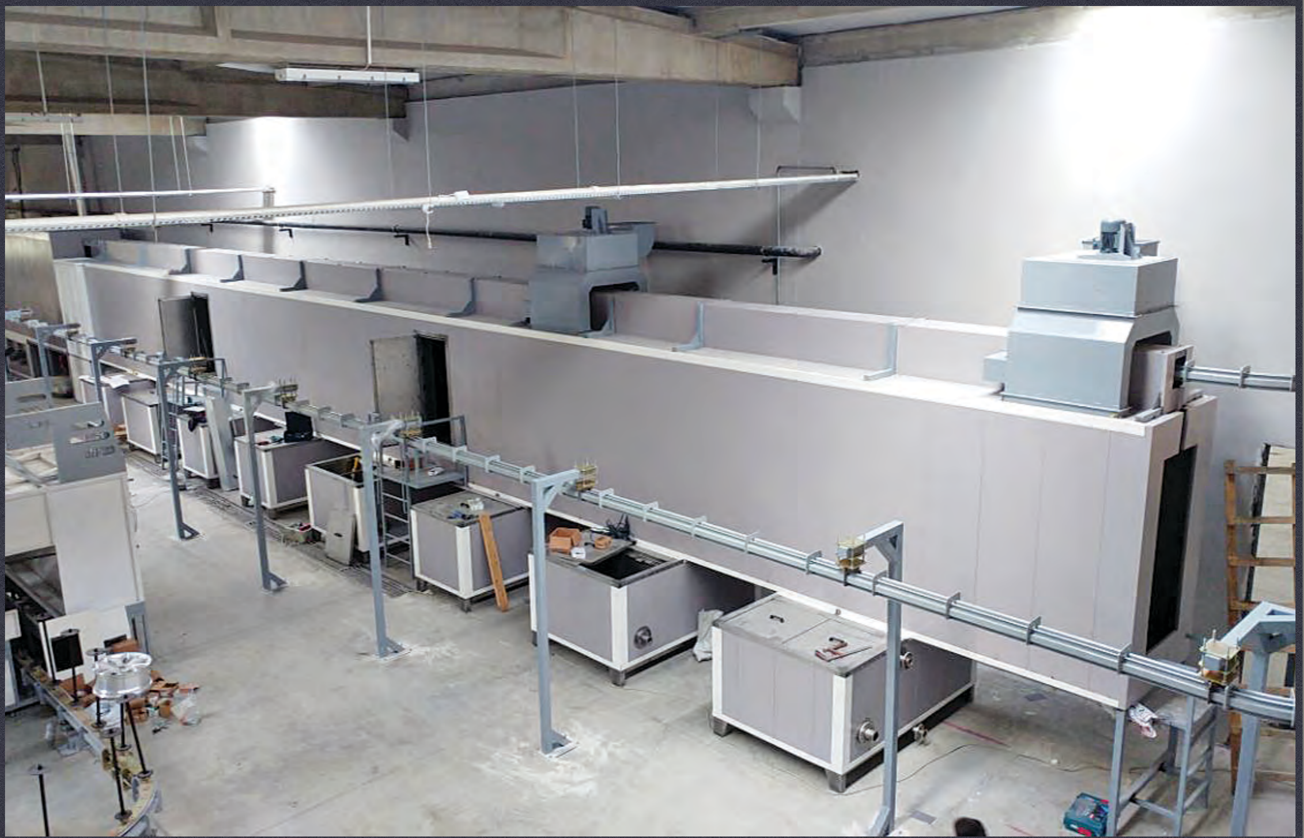
СИСТЕМИ ЗА ХИГИЕНИЗИРАНЕ, ОБЕЗМАСЛЯВАНЕ И ФОСФАТАЦИЯ / PREATREATMENT SOLUTIONS
